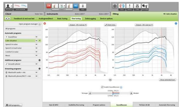
非線性頻率壓縮調整工具可擴展，以個別調整切割頻率和壓縮比。點一下[\[顯示更多選項\]](#)以使用此功能。
